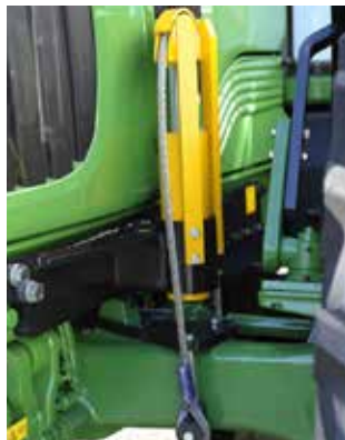
Voorasstabilisatie is geen overbodige luxe. Links voor een vaste vooras en rechts voor een geveerde vooras.
