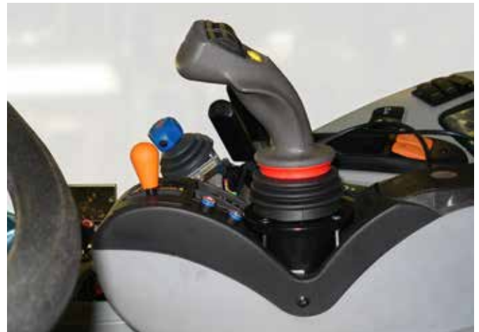
Elektrische joystickbediening is als optie verkrijgbaar. Ook is het mogelijk om te kiezen voor een extra bediening van de zweefstand naast de rechter joystick, zodat het bedieningspaneel achterin de cabine geplaatst kan worden.
