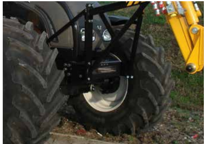
Werktuigdrager aan voorzijde van het aanbouwframe. Hier rust de giek op in transportpositie.
