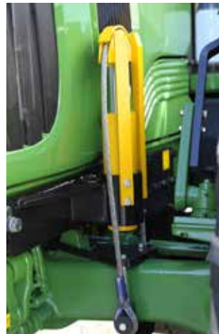
Voorasstabilisatie is geen overbodige luxe. Links voor een vaste vooras en rechts voor een geveerde vooras.
