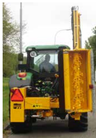
Achterlichten met magneet stellen u in staat om flexibel met verlichting om te gaan en dus toepasbaar op alle mogelijke werktuigen.
