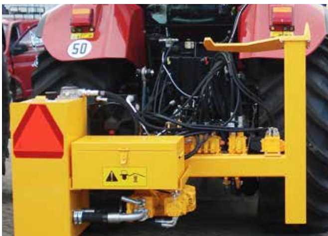
Eenvoudige doch functionele hydrauliekunit gedragen in de 3-punt van de tractor gecombineerd met een transportsteun aan de achterkant.
